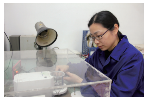
张玮正在使用百万分之一的高精密电子天平对样品称重。
