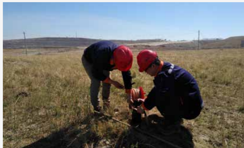
地下水水位观测
